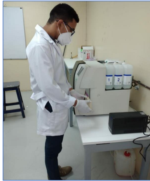
Lectura de las muestras en el equipo Dual 10 mediante el método HPLC (BIO-RAD).
