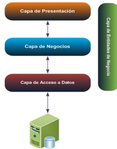
Figura 0-4 Estructura de N-Capa
