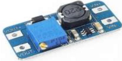
**Figura 25: Modulo Amplificador MT3608**
