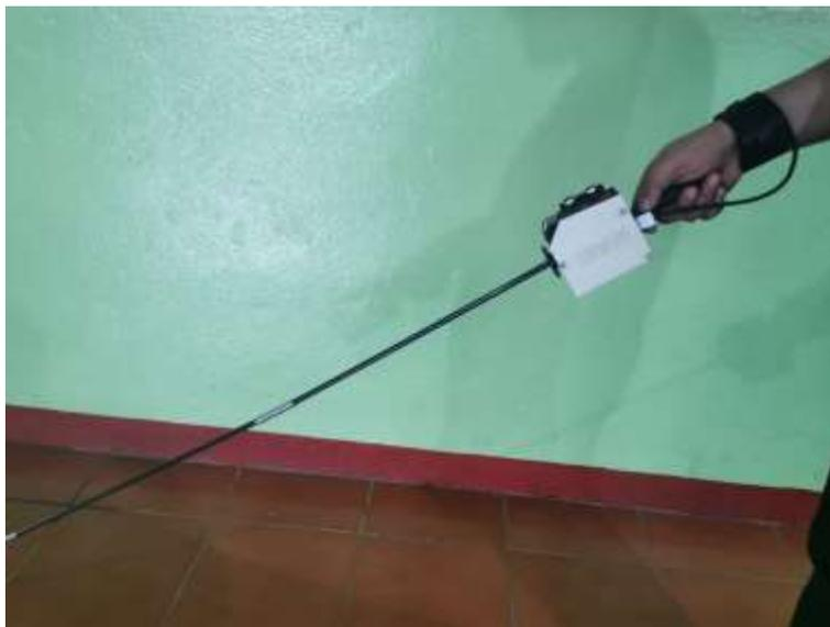
**Figura 52: Prueba de detección de obstáculos**
