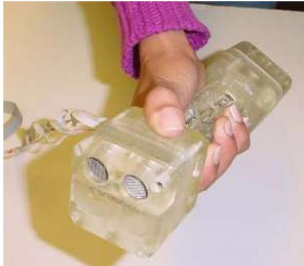
Figura 7: Dispositivo de retroalimentación táctil de mano
