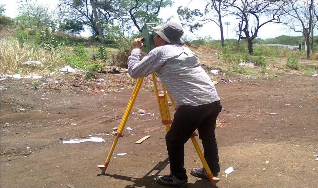
**Imagen.10.3. Levantamiento topográfico.**
