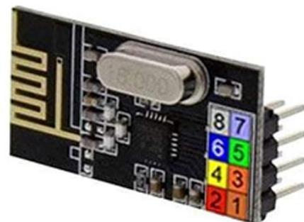
Figura 26: Descripción de pines del transceptor nRF24L01+
