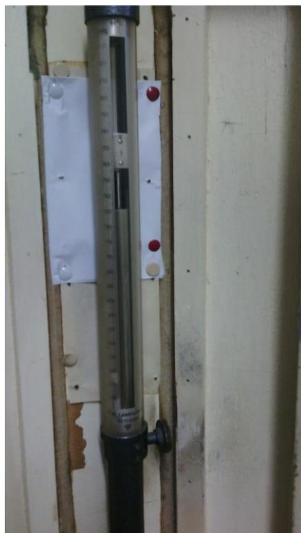
*Figura A5 - 2: Barómetro de mercurio*
