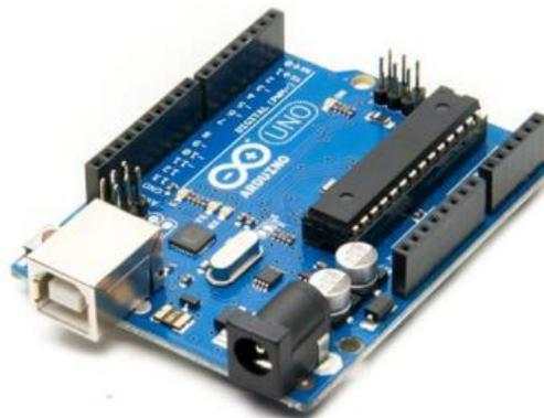
*Figura 14: Arduino UNO R3, formato DIP.*
