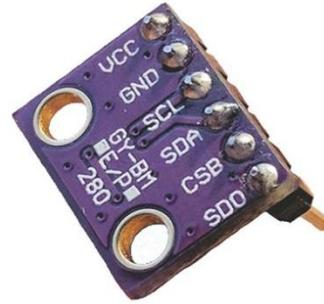
*Figura 36: Descripción de pines del sensor BMP280.*
