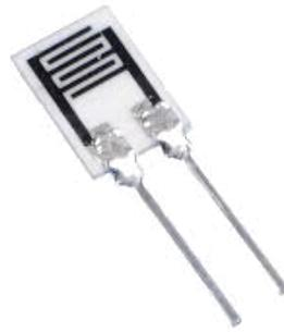
*Figura 9: Sensor de humedad resistivo.*
