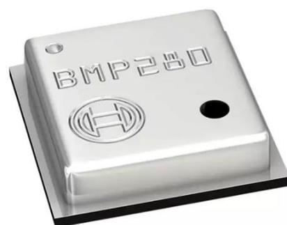
Figura 34: Sensor de Presión Absoluta BMP280
