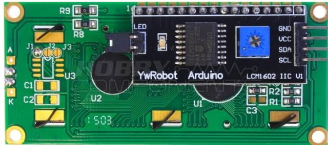
Figura 49: LCD 1602 con interfaz I2C.
