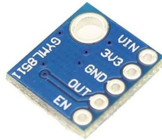
Figura 39: Descripción de pines del sensor ML8511.
