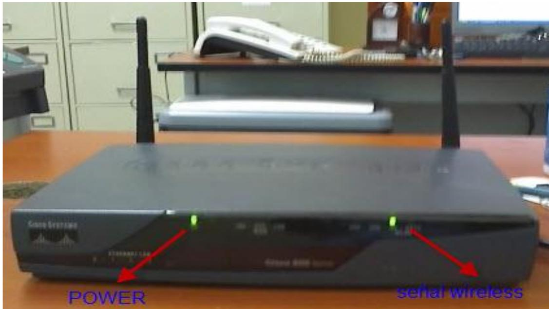
*Fig30 parte frontal del Router cisco 871W*
