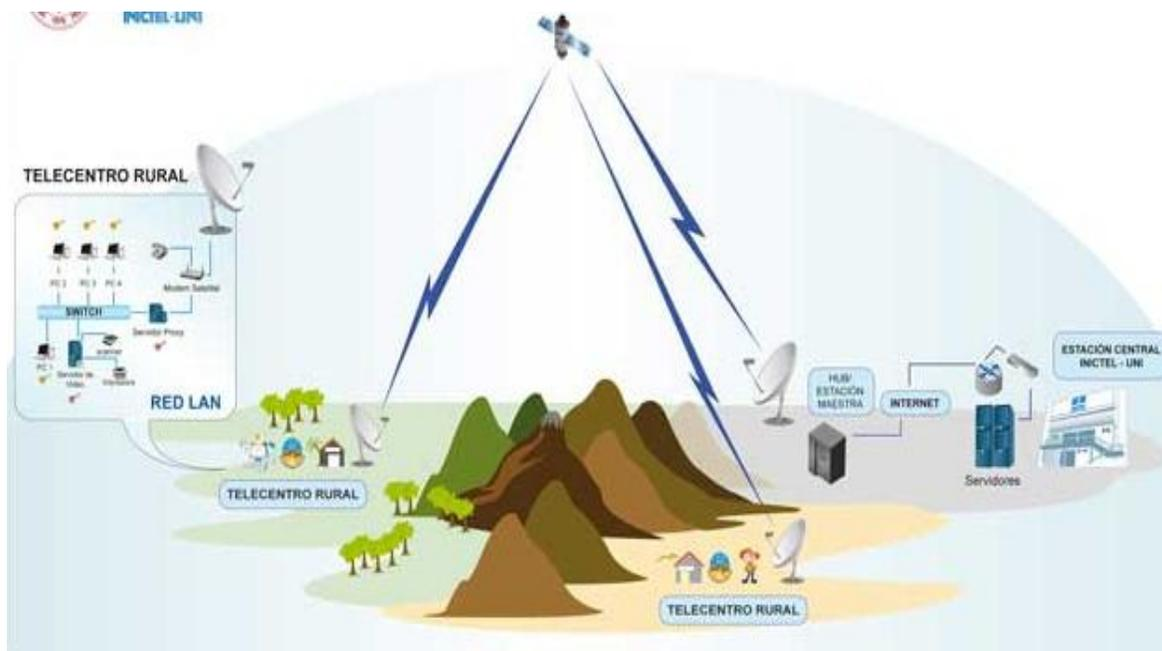
Fig.18 Conexión Vsat
