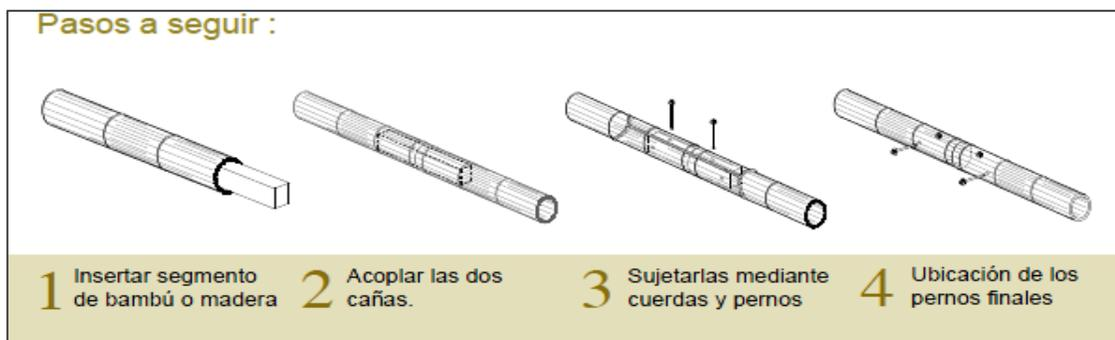
**ESTRUCTURA PORTANTE:** En las construcciones con bambú se utiliza caña rolliza como material de estructura portante. Las columnas no pueden enterrarse directamente en el suelo o empotrarse en el hormigón, por lo que se requiere una cimentación adecuada que aisle el bambú de la humedad del suelo y de la lluvia.
