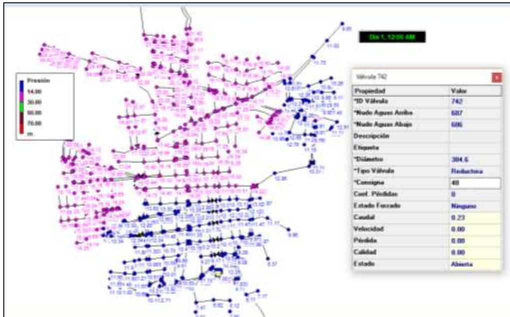
Imagen #40: propuesta de válvula de salida del tanque.
