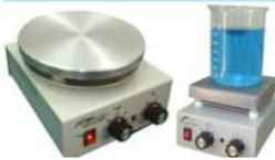
El plato caliente o plato agitador ha sido desarrollado con el propósito de calentar y mezclar fluidos contenidos en recipientes de laboratorio como Erlenmeyer, tubos de ensayo y tubos de precipitado.
