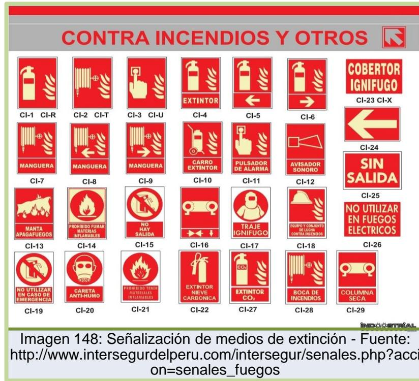
Imagen 148: Señalización de medios de extinción - Fuente: [http://www.intersegurdelperu.com/intersegur/senales.php?accion=senales\\_fuegos](http://www.intersegurdelperu.com/intersegur/senales.php?accion=senales_fuegos)
