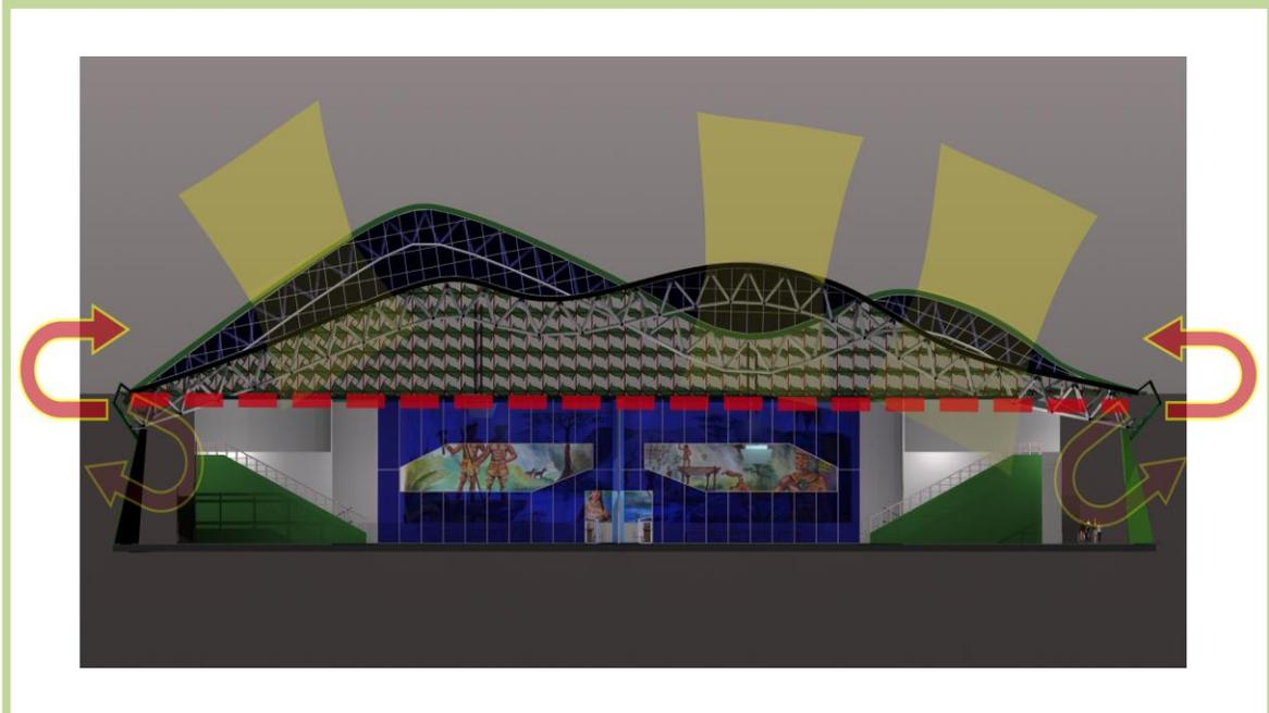
Imagen 128: Iluminación y ventilación - Sección Coliseo deportivo - Fuente: Elaboración propia
