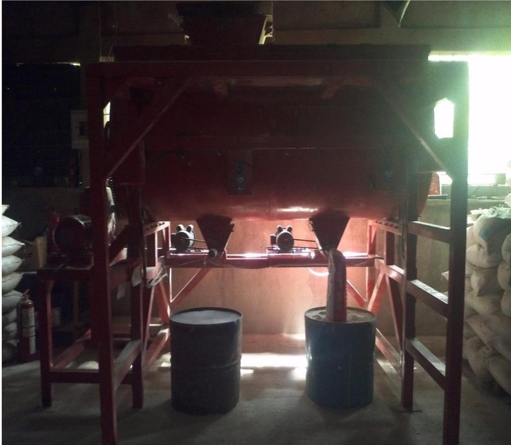
**Ilustración 27. Unidad productora de pegamentos para piso y cerámica (Bondex)**
