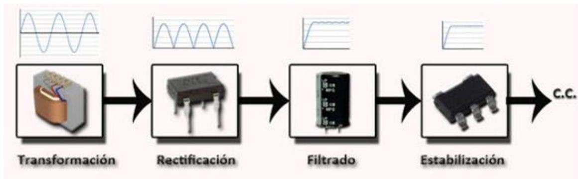
Figura 1.2: Etapas de transformación de C.A. a C.C.
