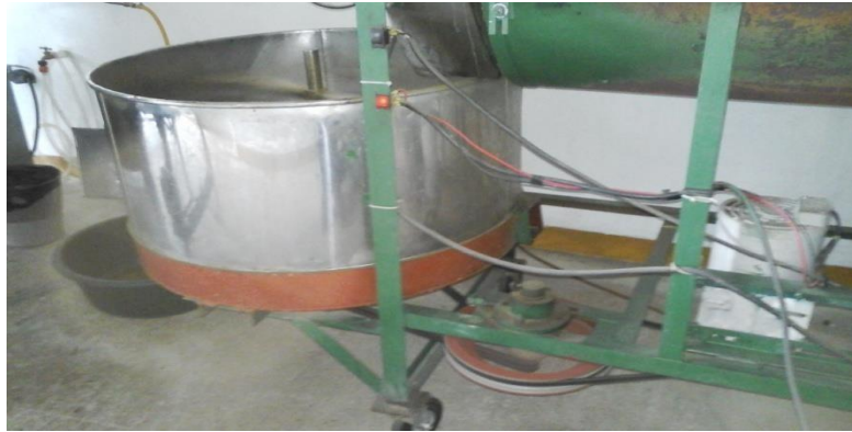
Figura N° 24. Máquina de tostado sin resguardo en las bandas.
