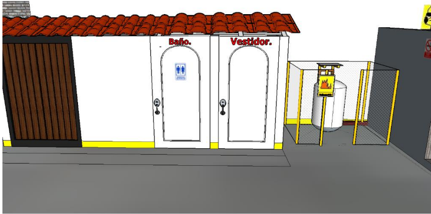
Figura N° 56. Reubicación y protección de tanque LP (Gas Butano).
