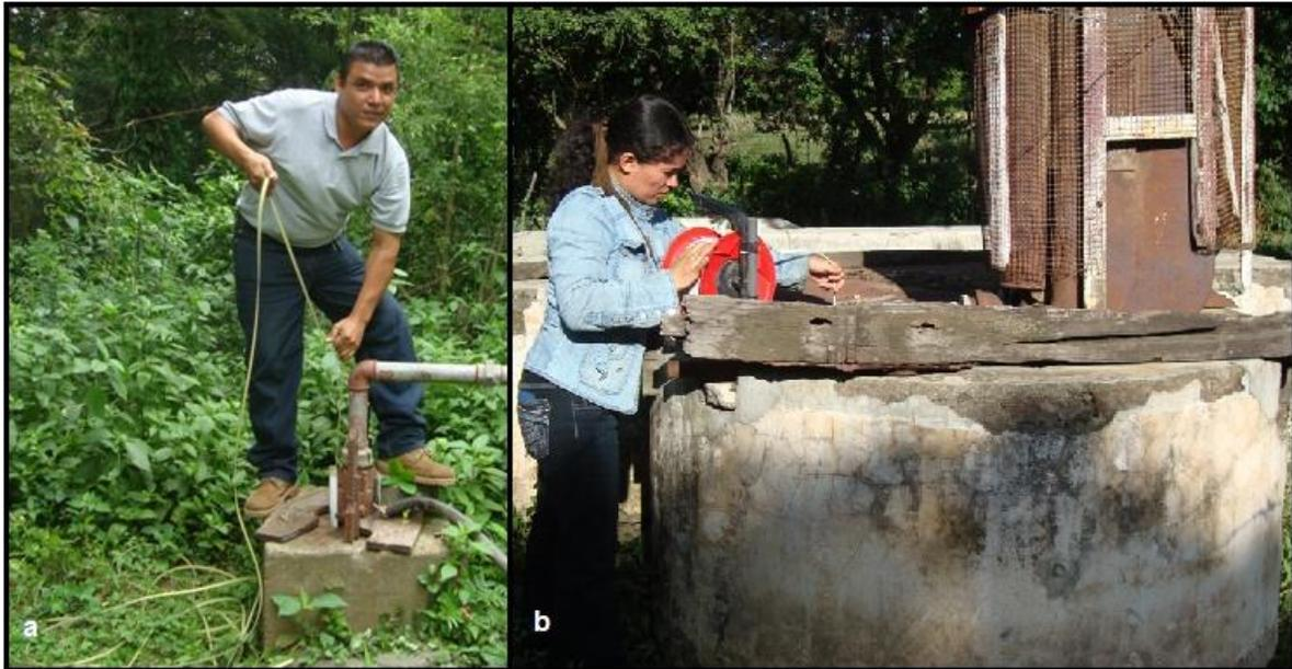
**Figura 11: Medición de NEAS. a) Pozo perforado Filos de Cuajachillo, localizado al sur del escarpe Mateare b) Pozo excavado Los Laureles, localizado al suroeste de Ciudad Sandino.**
