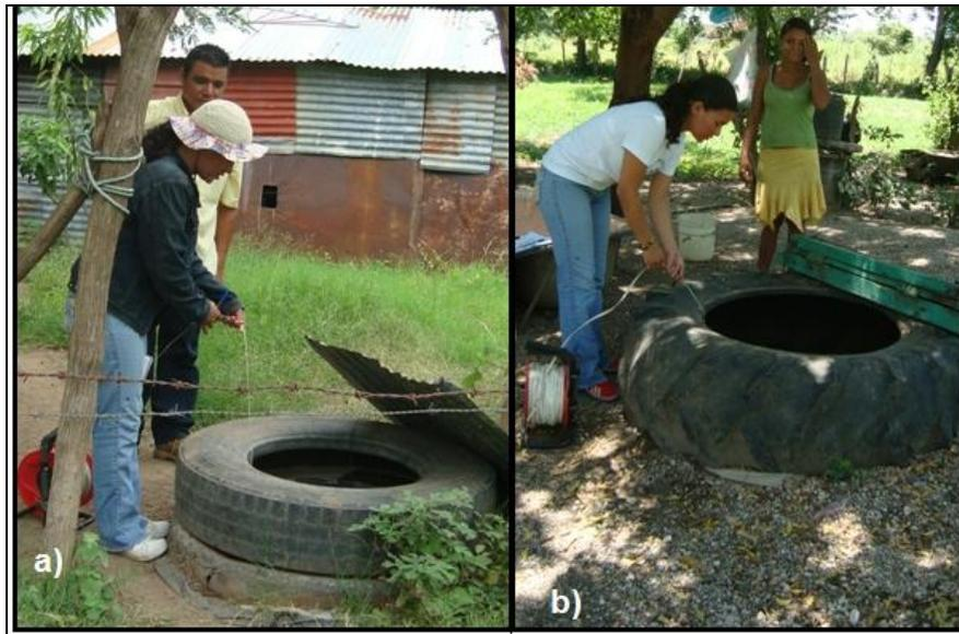
**Figura 6: Mediciones de nivel de agua. a) Pozo localizado en el municipio de Mateare. b) Pozo de propiedad privada ubicado en la carretera Mateare Xiloá. Ambas mediciones se realizaron con la sonda de 100 m de longitud.**
