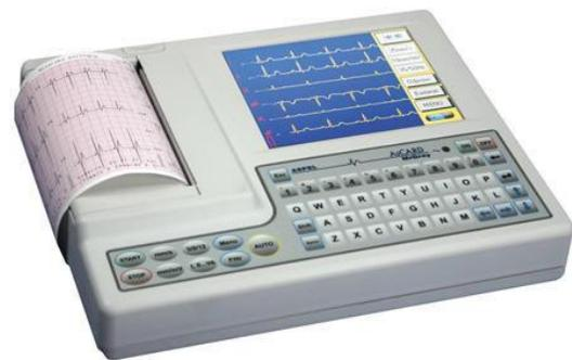
El funcionamiento del electrocardiógrafo, como equipo de diagnóstico clínico, se basa en la instalación de una serie de electrodos en la superficie de la piel del paciente a nivel de la
