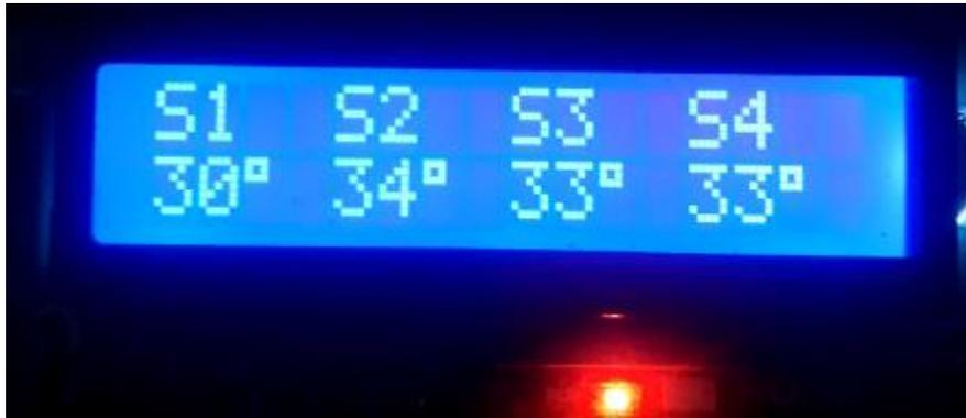
*Figura 19. Datos en tiempo real a través de pantalla LCD*
