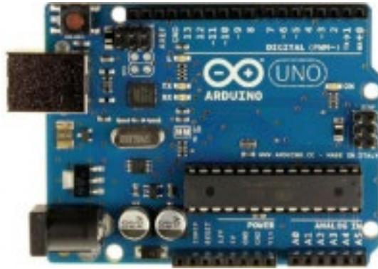
Figura 7. Microcontrolador Arduino UNO
