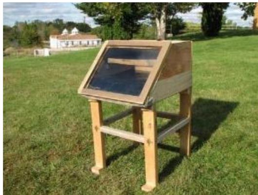
*Figura 1. Modelo de deshidratador solar indirecto*
