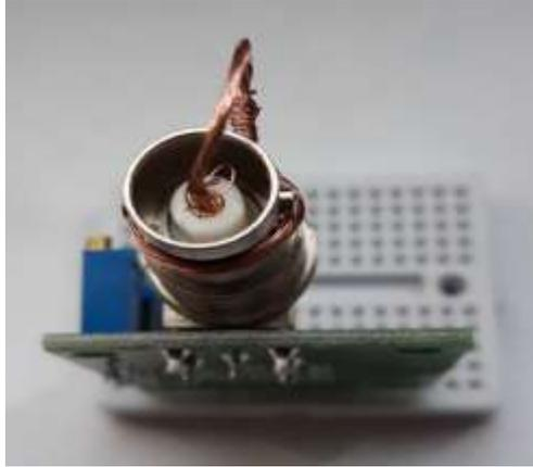
*Ilustración 15 cortocircuitado para calibración del módulo
