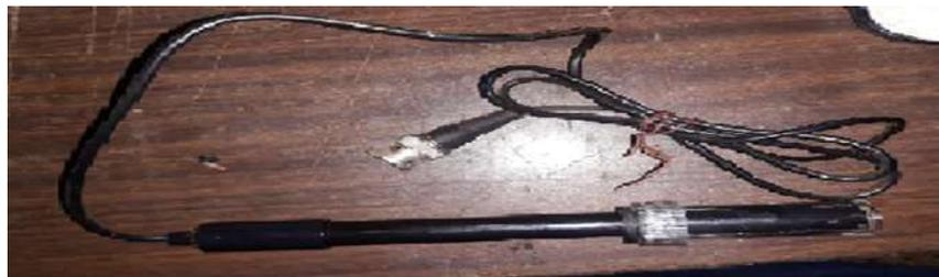
*Ilustración 13 Sonda e201 pH fuente propia*
