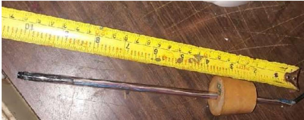
*Ilustración 17 Sonda sensor de temperatura fuente propia*
