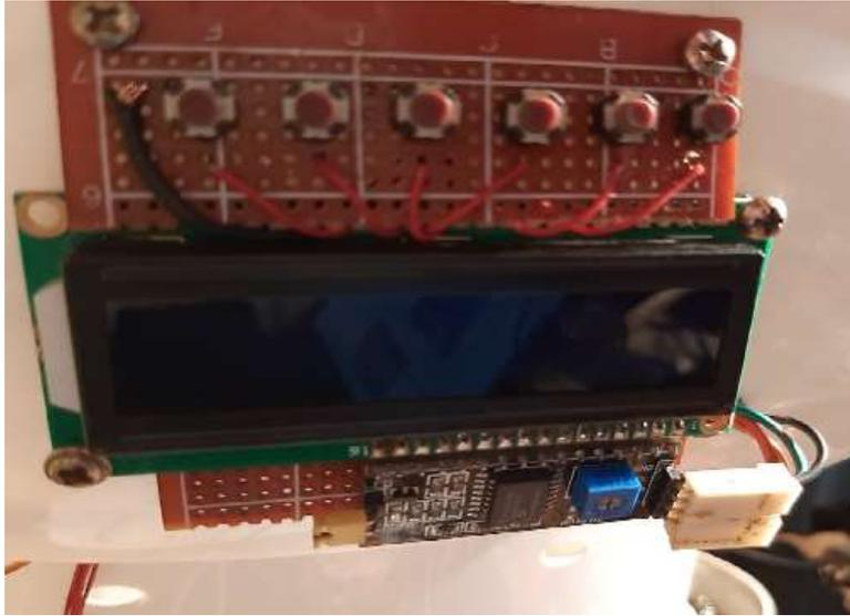
*Ilustración 74 Conexión de Botonera, I2C y pantalla LCD
