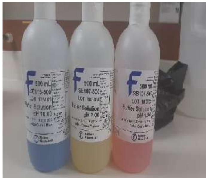
Ilustración 67 Soluciones de pH para calibrar facilitado por el Laboratorio
