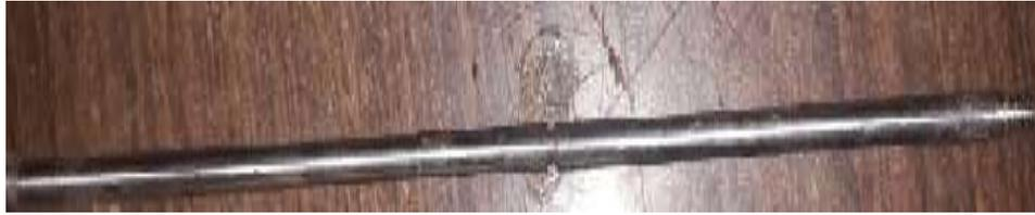
*Ilustración 25 Eje de agitador con unión cónica
