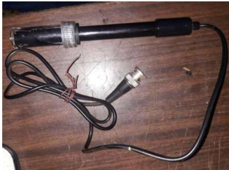
*Ilustración 69 Sonda de pH fuente propia*
