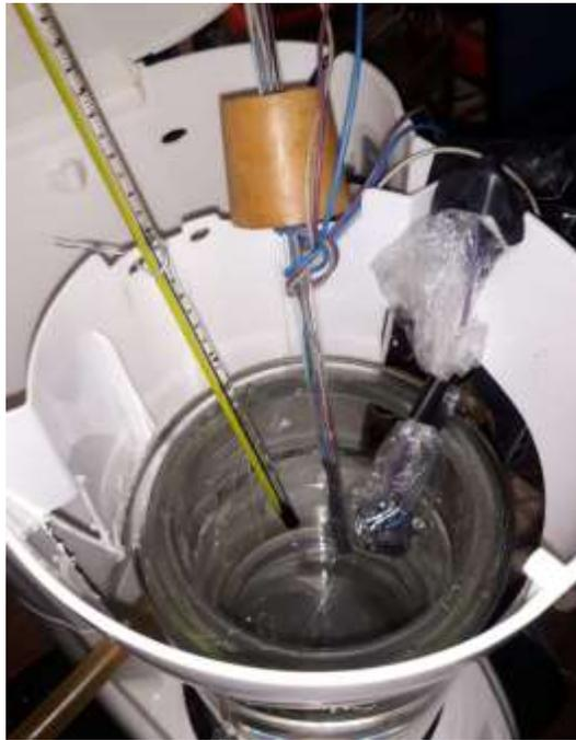
*Ilustración 57 Calibración del sensor 18B20 con termómetro de mercurio Fuente propia*
