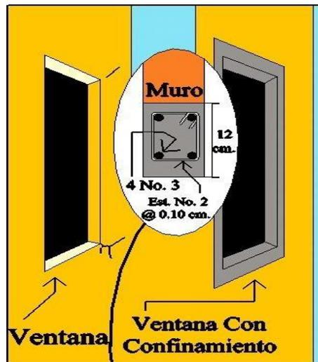
54. Asociación colombiana de ingeniería sísmica. (2001). Especificaciones para el confinamiento de ventanas. [Figura] Recuperado de [http://www.preventionweb.net/files/7661\\_ManualdecasasdemamposteriaAISredpart1.pdf](http://www.preventionweb.net/files/7661_ManualdecasasdemamposteriaAISredpart1.pdf)
