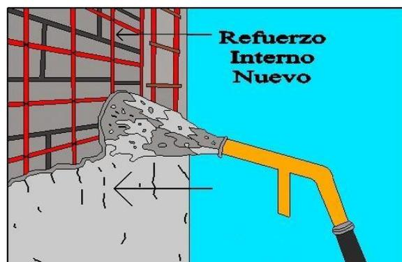
50. Asociación colombiana de ingeniería sísmica. (2001). Aplicación de mortero de repello para recubrimiento de malla de refuerzo. [Figura] Recuperado de [http://www.preventionweb.net/files/7661\\_ManualdecasademamposteriaAISredpart1.pdf](http://www.preventionweb.net/files/7661_ManualdecasademamposteriaAISredpart1.pdf)
