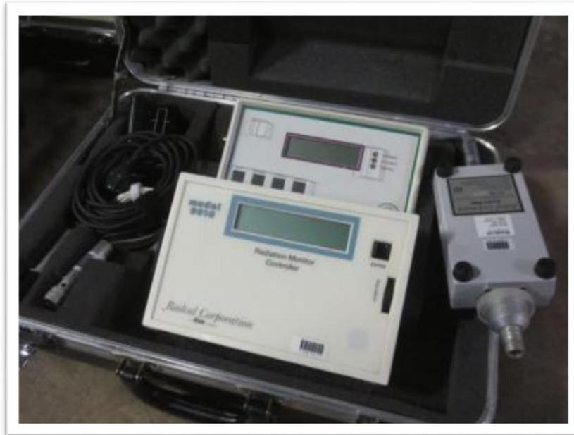
Imagen3. Sistema de medición Radcal model 9010
