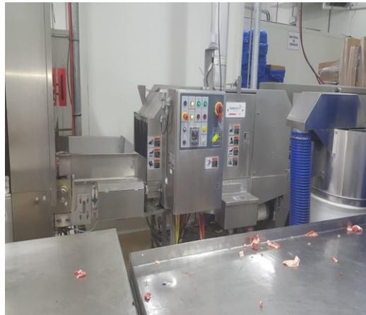
*Ilustración 0-15 Máquina de Termo encogido*
