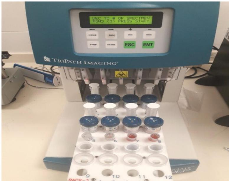
**Luego cada vial es puesto en una gradilla junto con un tubo cónico y una jeringa los cuales previamente rotulados se colocan uno de cada uno para cada vial, posteriormente se coloca en el equipo de TRIPATH IMAGING, en el que de manera automatizada hace que la jeringa se introduzca en el vial y extraiga la muestra contenida y la deposite en el tubo cónico específico para cada vial.**
