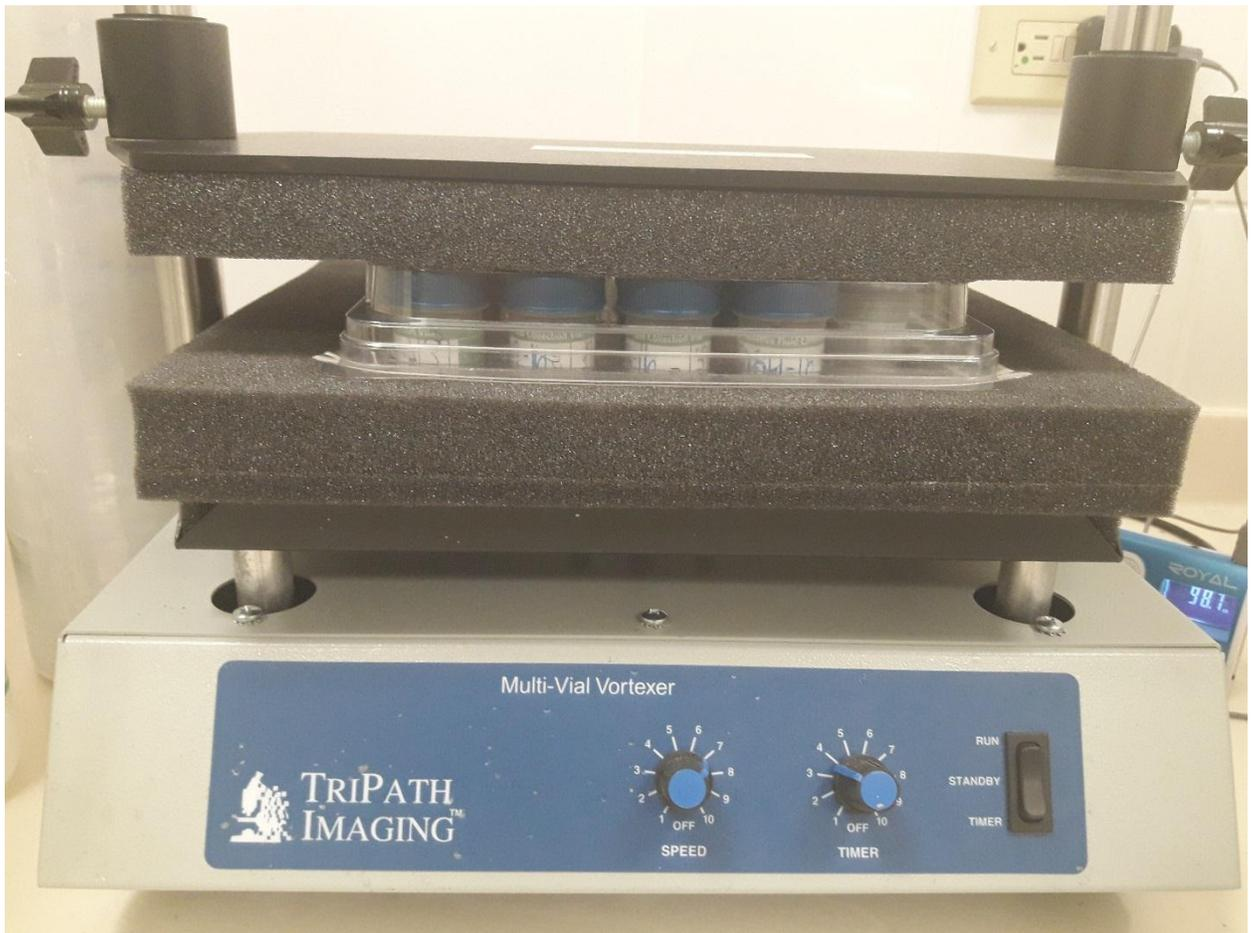
**Se colocan los viales en el Multi vial Vortexer para agitar la muestra con movimientos de vibración para que las células en el citocepillo se desprendan y se mezclen con el líquido de fijación contenido en el vial.**
