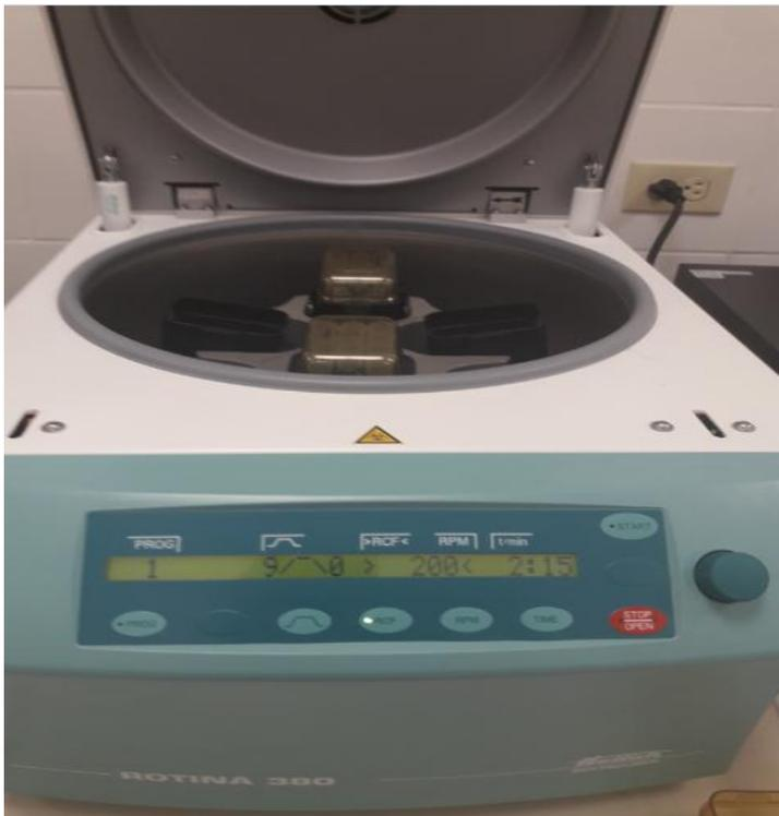
Una vez colocada la muestra en cada tubo cónico se colocan en el equipo de centrifugado y mediante 2 procesos en tiempos y a diferentes revoluciones este permite que se separen las células de todo desecho o contaminación contenido en la muestra y se forma el botón celular.
