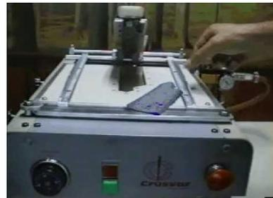
**Fig. 17:** Planchar bolsa trasera (automática)
