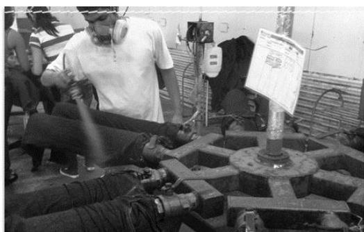
**Fig. 6:** Operario aplicando resina
