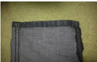
**Fig. 18:** Sorgetar paneles delanteros parte externa.
