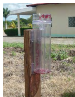
Figura 23 Pluviómetro ubicado en el sitio de estudio -TAINIC
