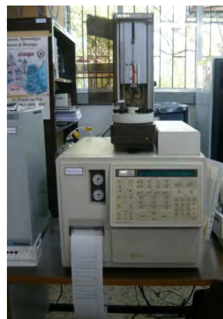
Figura 13. Cromatógrafo de gases modelo VARIAN 3400. CIRA/UNAN, 2012.
