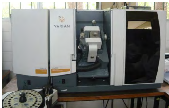
Figura 22 Espectrómetro de absorción atómica modelo VARIAN SpectrAA-240FS. CIRA/UNAN, 2012.
