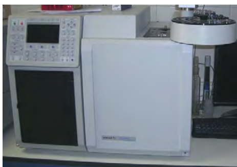
Figura 12. Cromatógrafo de gases modelo VARIAN 3000. CIRA/UNAN, 2012.
