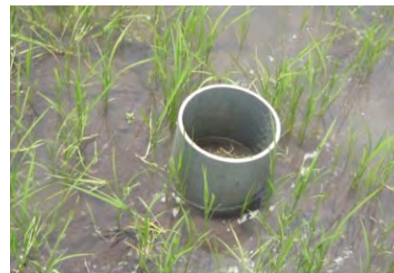
Figura 8 Tubo medidor hecho de PVC, en los campos de arroz
