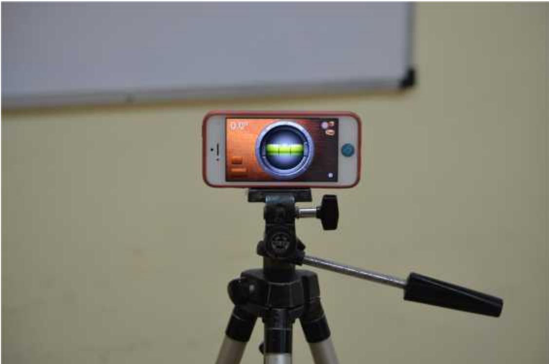
**Fig. 17-** Se muestra la nivelación del cabezal desmontable donde va ubicada la cámara.
