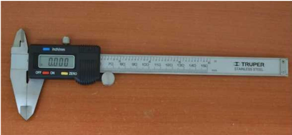
**Fig. 18-** Pie de rey digital marca TRUPER con el que se realizó las medidas para obtener el biotipo facial.
