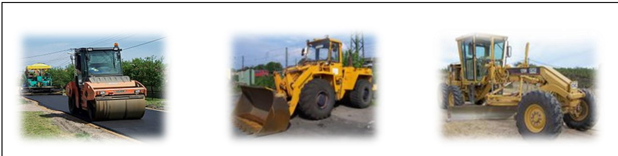
Fig. 8. Equipos de Construcción: Apisonador, Cargador frontal sobre llantas, Motoniveladora.
