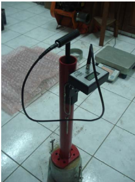
A.5.11 Colocación de Martillo Clegg sobre espécimen.
