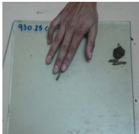
A.5.3 Ensayo de límite plástico.
