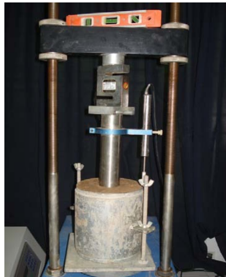
A.5.9 Ensayo CBR sin saturar.
