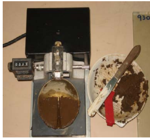
A.5.2 Ensayo de límite líquido.
