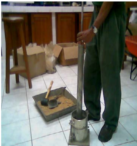
A.5.4 Ensayo Proctor Modificado.
