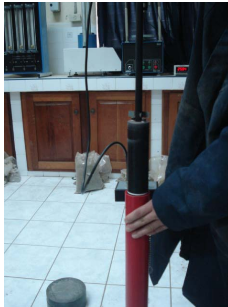
A.5.12 Martillo a nivel de referencia para ejecución de ensayo VIC.
