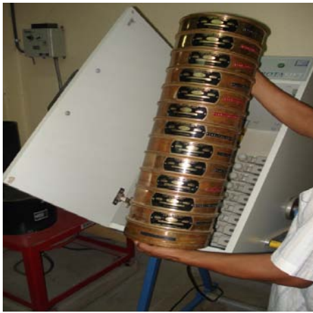
A.5.1 Ensayo de granulometría.
