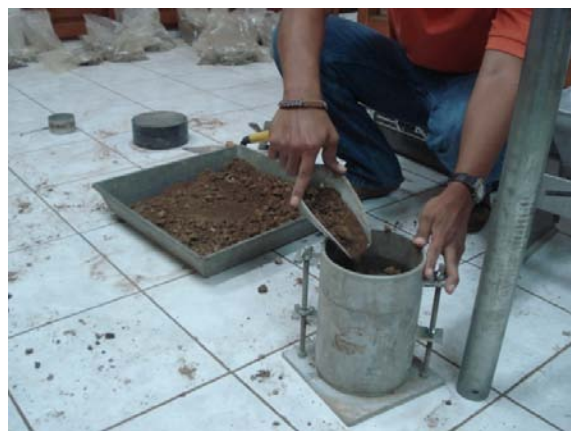
A.5.7 Fabricación de especimen.
