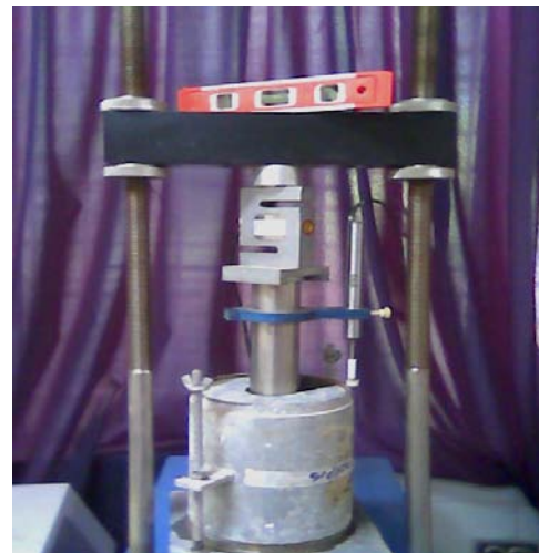
A.5.5 Ensayo CBR.
