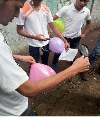
Foto 1: Estudiantes concentrando la luz solar con ayuda de una lupa a un punto fijo del globo.
