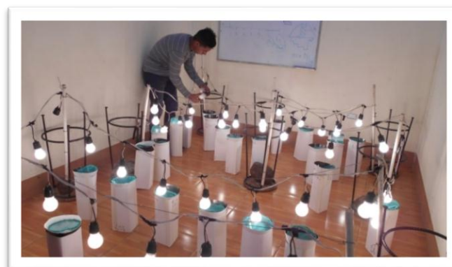
Fotografía 3: Funcionamiento del Sistema Berlesse- Tullgren, para realizar la extracción de los artrópodos. Tomada por: Isaac Talavera
