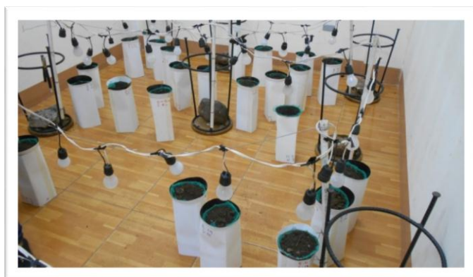
Fotografía 4: Sistema Berlesse- Tullgren, ubicación de muestras de suelo para realizar la extracción de los artrópodos.
