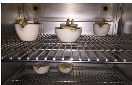
Figura 5. Muestras en Crisoles en Horno a 550 ° C.
