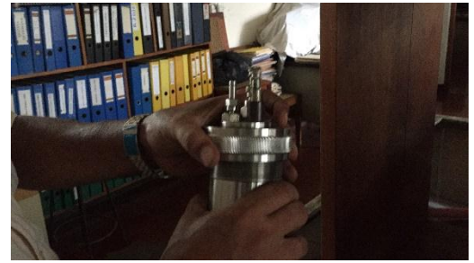
Figura 12. Armado de conductor en camisa de bomba.
