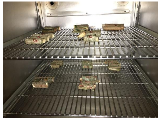
Figura 7. Horno para Secado de Muestras a 105 °C.
