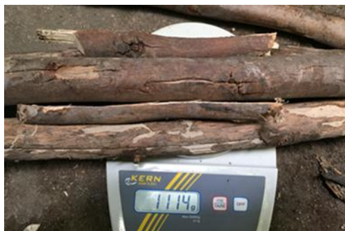
Figura 15. Pesado de 1,114 gramos de Leña para Prueba de Cocción.
