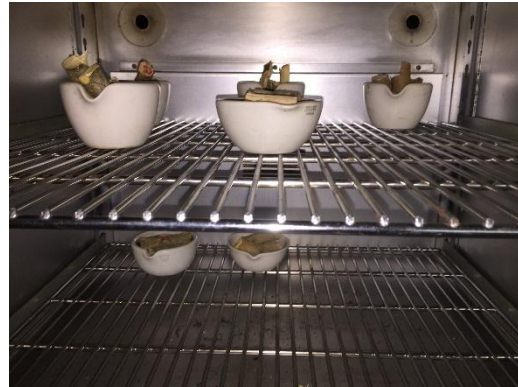
Figura 8. Muestras en Crisoles en Horno a 550 ° C.
