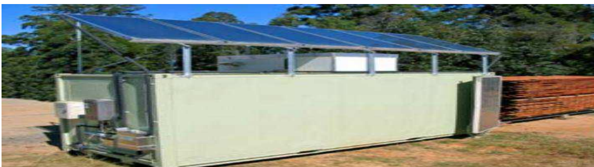
Figura 2. Horno de secado de madera híbrido Solar-gas natural.
