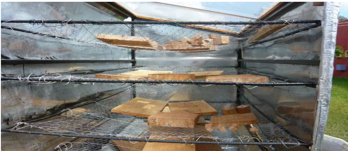
Figura 3. Estructura de la cámara de secado
