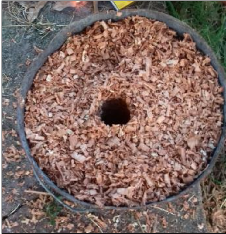
Figura 20. Desechos biomásico en el dispositivo térmico.
