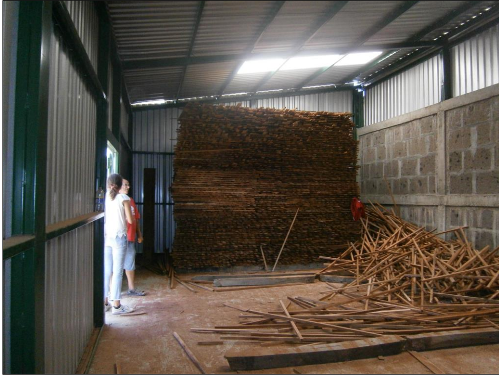
Figura 23. Secador solar industrial ubicado en santa cruz Estelí
