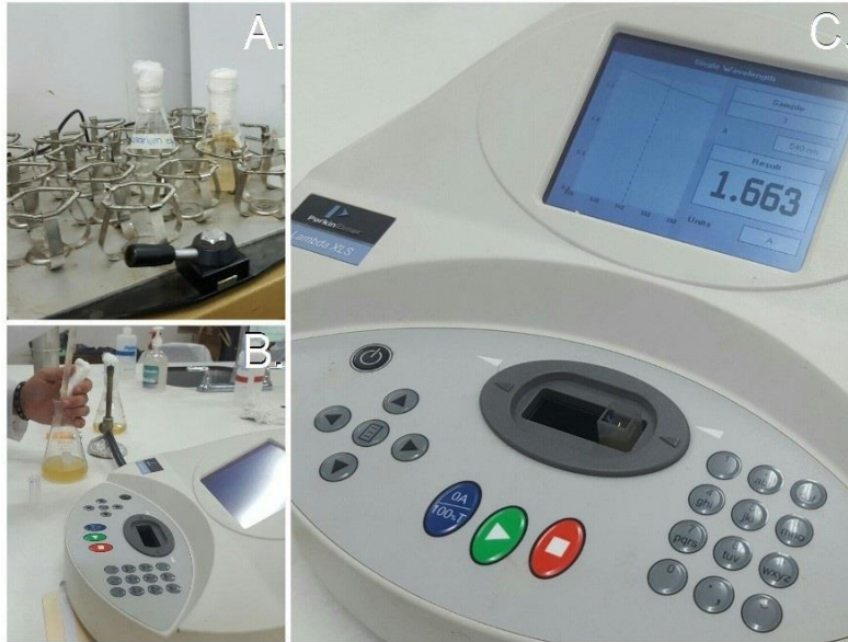
Figura 24. A. Muestra en agitación en shaker, B. Colocación de muestra en celda, C. Medición de absorbancia en espectrofotómetro.
