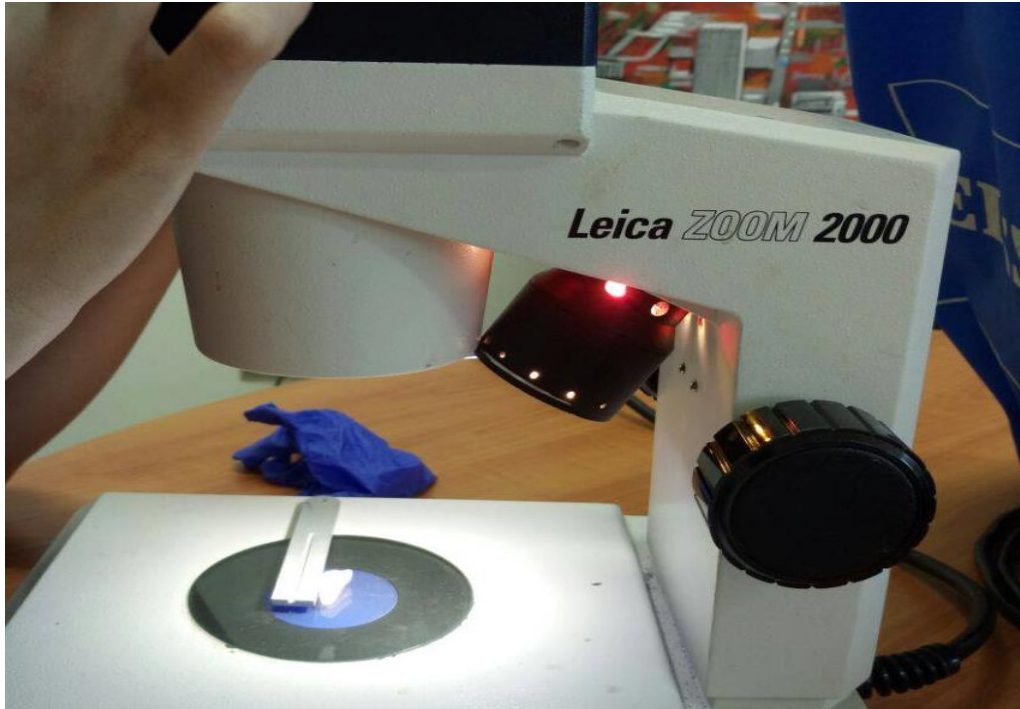
Figura 10 Observación de las piezas ya cortadas y después de haber sido sumergidas en tinta china por 16 días
