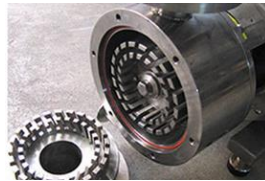
Figura 19. Neumatica de bomba homogeneizadora. Fuente: propia
