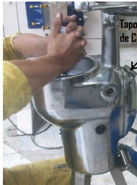
Figura 13. Tapón de lubricación de caja. Fuente: https://es.escribd.com/doc/99232996/Descremadora-de-Leche
