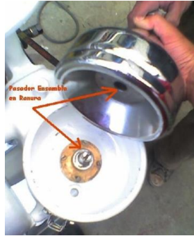
Figura 14. Eje propulsor. Fuente: https://es.escribd.com/doc/99232996/Descremadora-de-Leche
