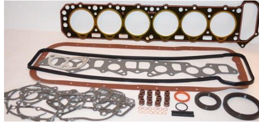
Figura 22. Juntas de motor. Fuente: propia
