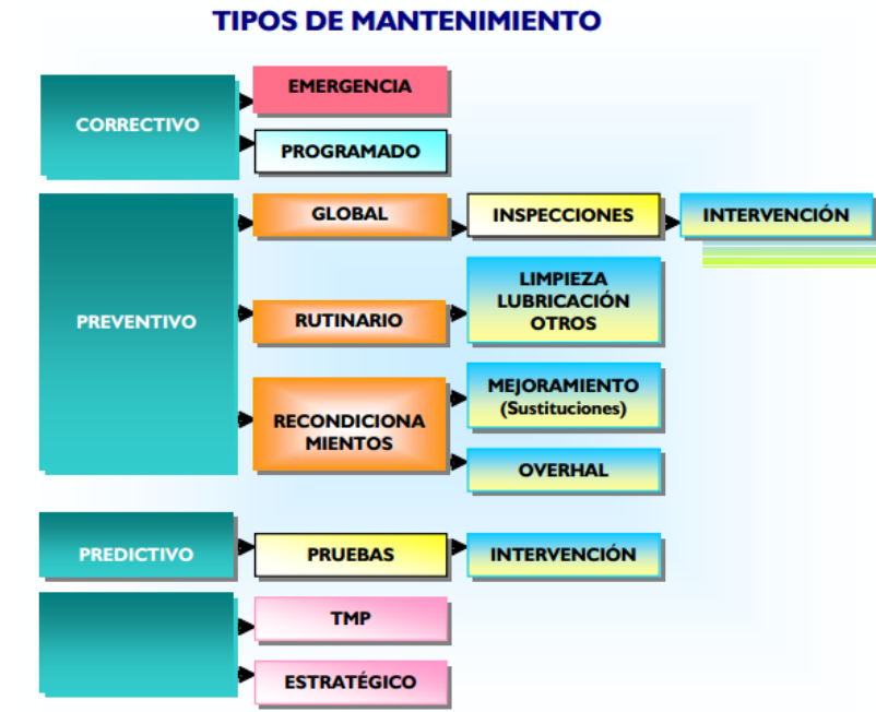
Figura 14. Esquema de los tipos de mantenimiento Fuente: Internet
