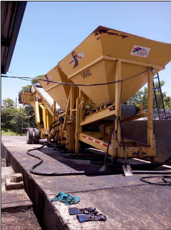
Figura 11: Tolvas de planta asfáltica (cap. 8m3). Figura 12: Llenado de tolvas con agregados.
