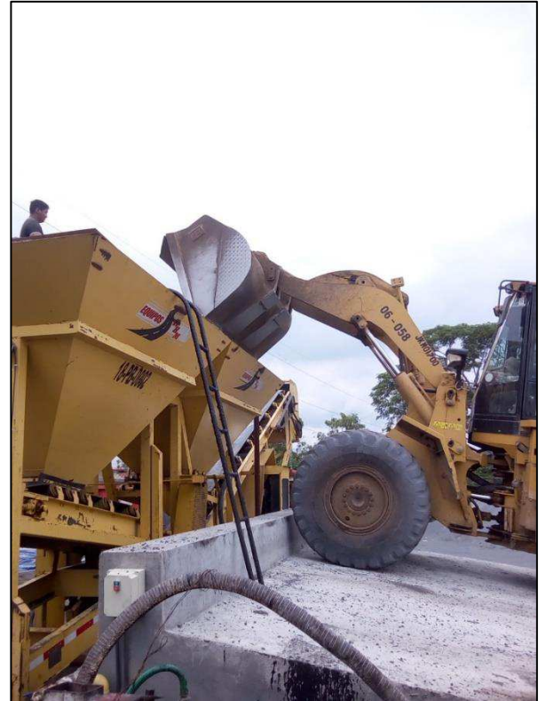
Figura 11: Tolvas de planta asfáltica (cap. 8m3). Figura 12: Llenado de tolvas con agregados.
