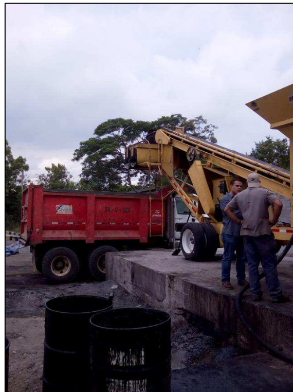
Figura 11: Tolvas de planta asfáltica (cap. 8m3). Figura 12: Llenado de tolvas con agregados.
