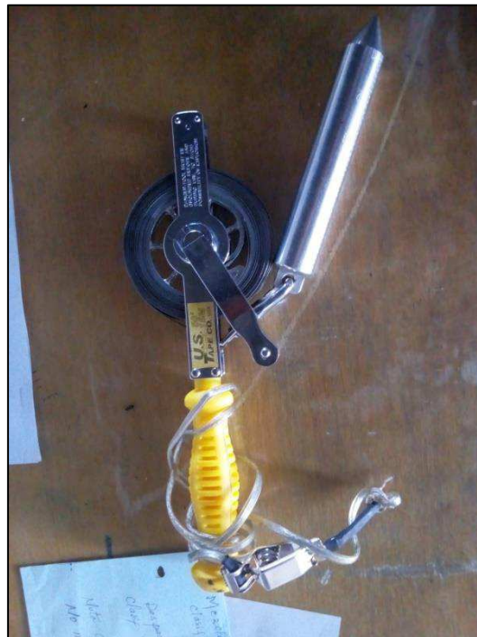
Figura 25: Cinta métrica para medir tanque de emulsión.
