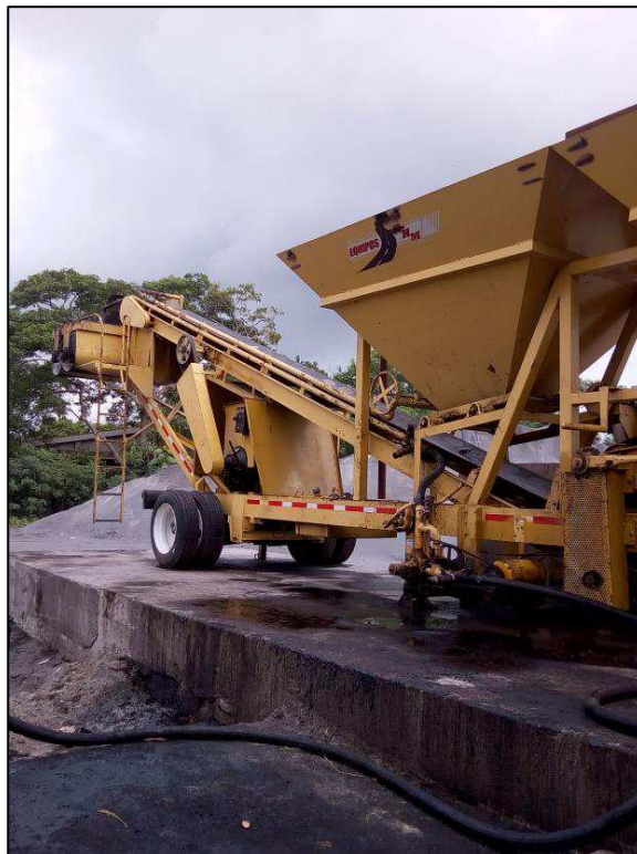
Figura 10: Planta asfáltica de alcaldía de Managua.
