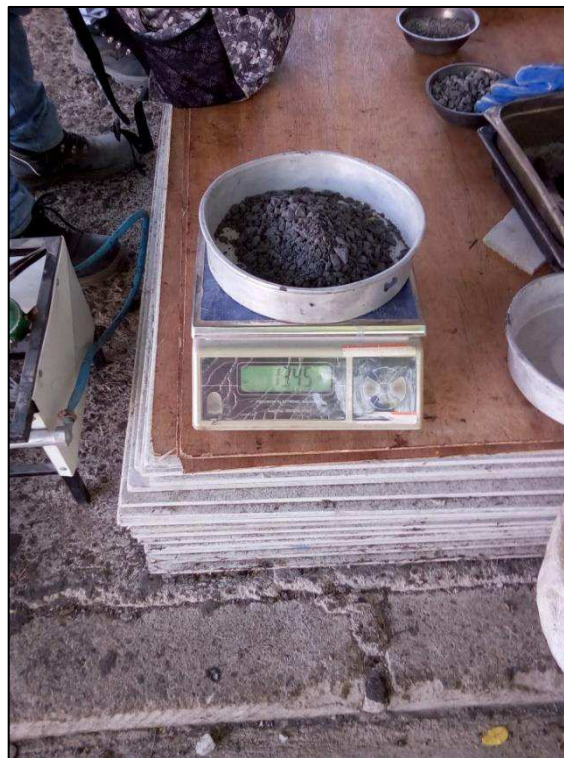
Figura 16: Pesaje de árido seco.
