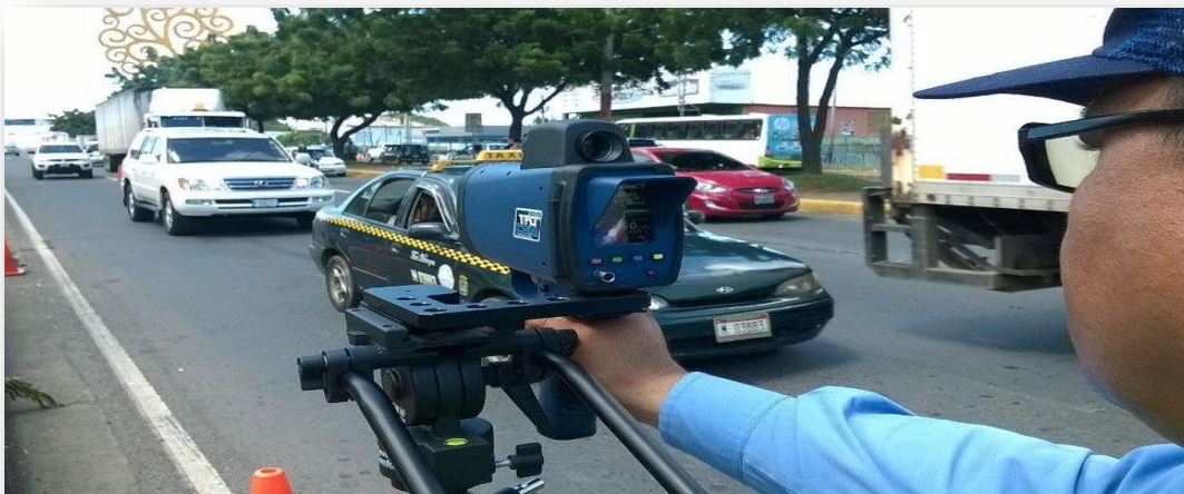
Figura 2.2: Radar de velocidad para medir la velocidad de los automóviles.
