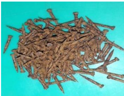
Figura 15. Clavos de hierro oxidados
