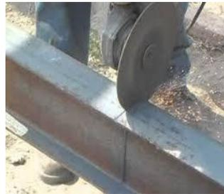
*Ilustración 7. Corte de lagarto boca de lagarto lleva soldadura corrida*
