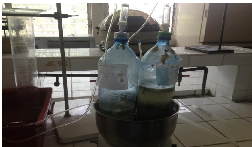
Figura 1ª experimento de obtención de biogás de basura orgánica de bares y comedores de la UNAN – Managua.
