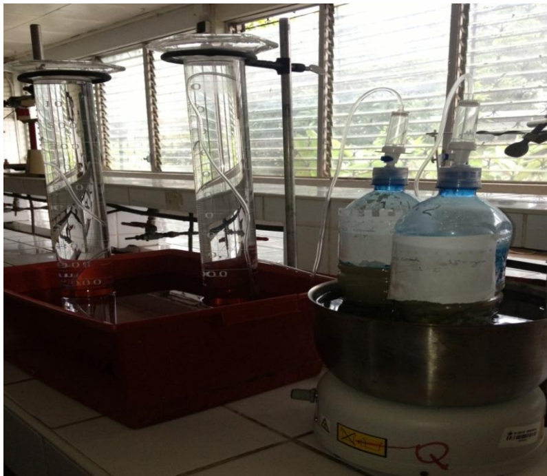
Figura 1ª experimento de obtención de biogás de basura orgánica de bares y comedores de la UNAN – Managua.
