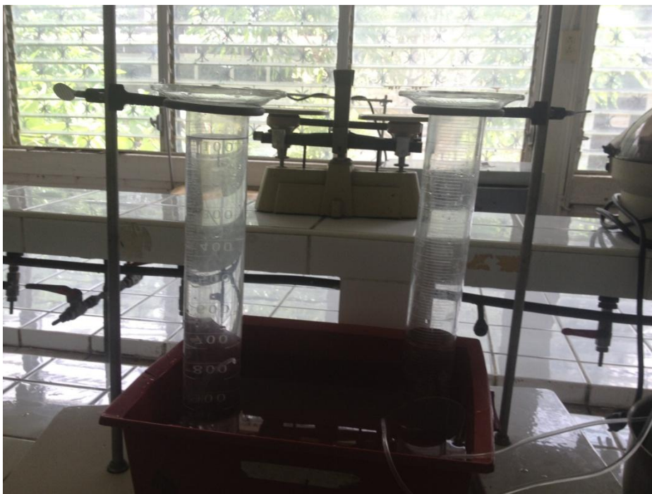
Figura 4ª contenedores de biogás.
