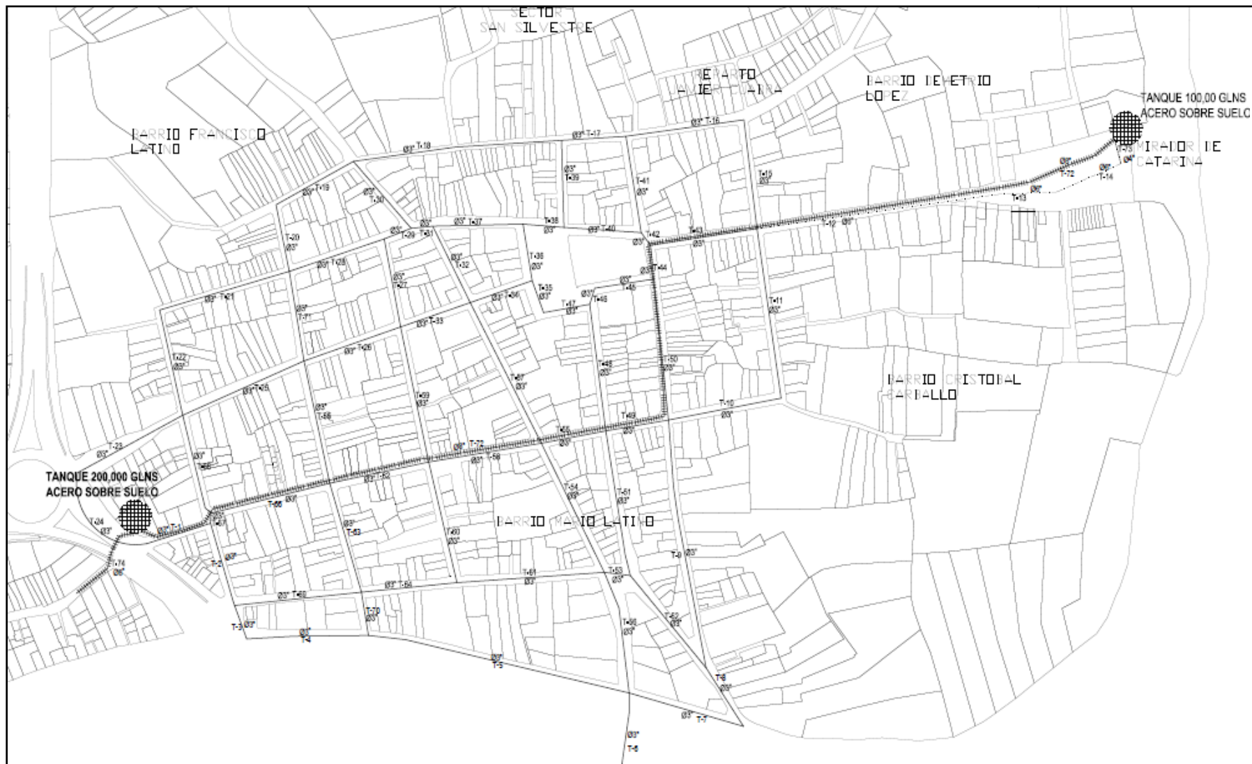
Ilustración 18: Esquema de Ubicación de Tuberías Existentes
