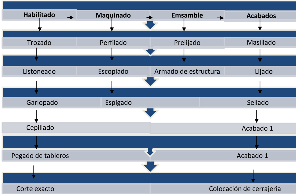
Gráfico N° 1 Proceso de fabricación de muebles
