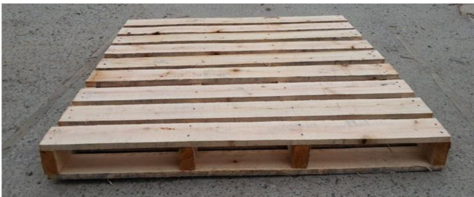
Figura 3. Polín utilizado para el apilamiento del producto.
