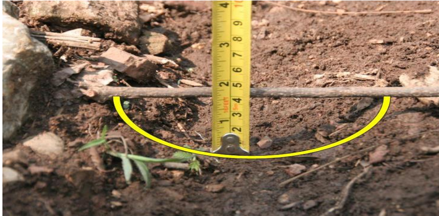
Gráfico 4. Forma de media elipse del surco de erosión (Blanco, 2011).
