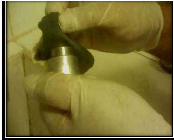
Fotografía 1. Pulido de piezas de acero al carbono
