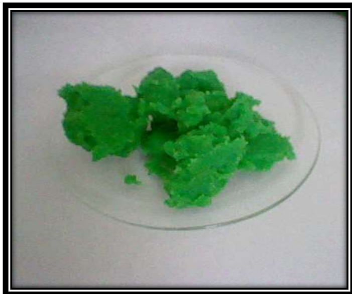
Fotografía 7. Sulfato de níquel
