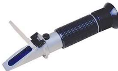
Imágenes No: 36, 37 y 38 (Equipo que se utilizó para los °Brix refractómetro de escala 0-30 °Brix)
