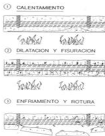
Figura 9 Alteraciones producidas en adherencia concreto acero.
