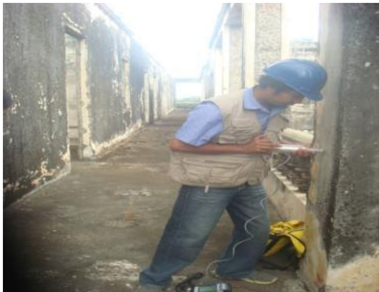
Figura 42 prueba con esclerómetro para obtener la resistencia a compresión de los elementos
