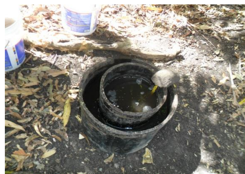
Foto 12. Prueba de infiltración en la parte SO de la caldera comunidad Los Bajos.
