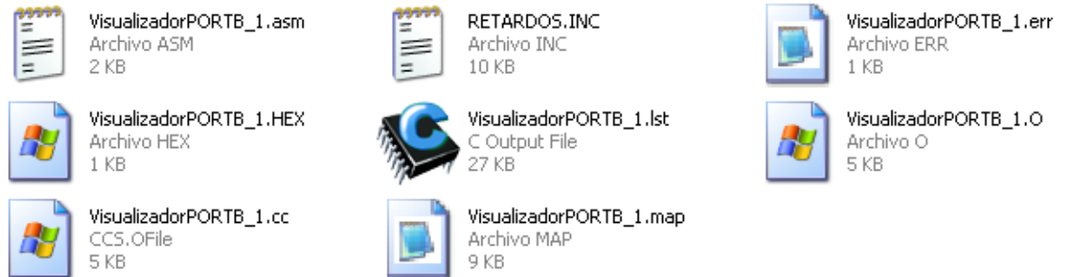
Figura 39. El MPLAB genera 6 archivos en la carpeta donde estaba el código fuente y la librería.
