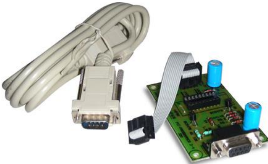
Figura 43. Grabador JDM para grabar el PIC se debe conectar al puerto serie COM1.
