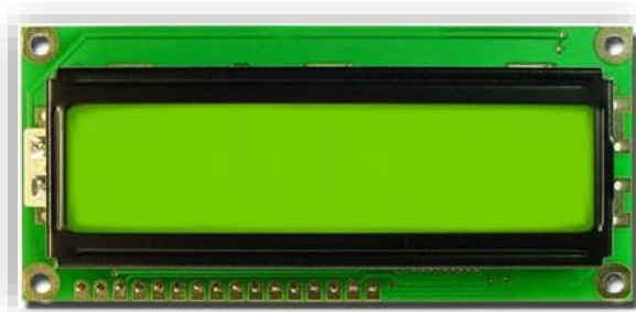
Figura 2.10 LCD 2x16: está compuesto por 2 líneas de 16 caracteres
